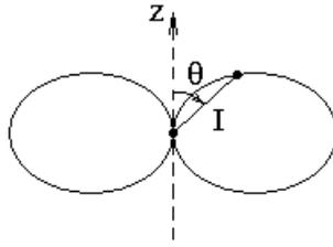
Из начала координат для каждого направления отложим отрезок, длина которого пропорциональна интенсивности излучения диполя в данном направлении, и поставим точку в конце отрезка. Соединим точки в концах отрезков для всех направлений и получим поверхность, которую называют диаграммой направленности излучения диполя.
