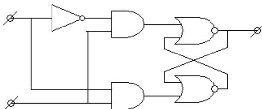
Если на нижний вход подать короткий импульс, то  $RS$ -триггер установится или сбросится в зависимости от состояния верхнего входа именно в момент короткого синхроимпульса.
