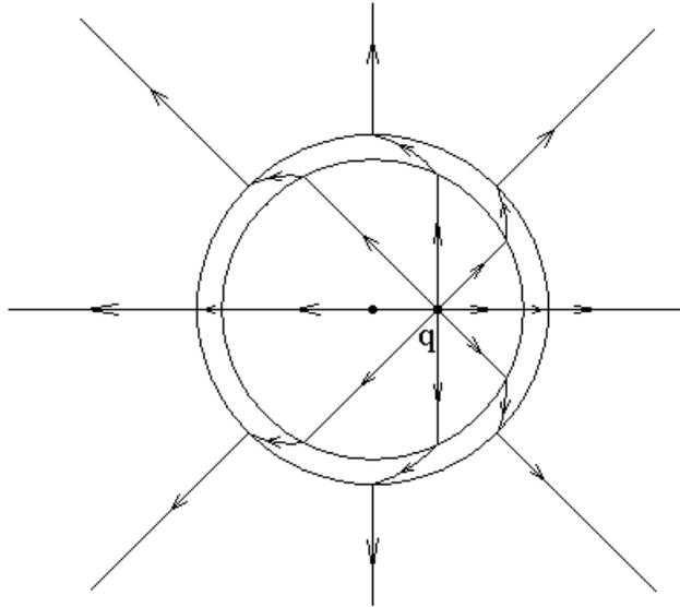
Пусть информация об ускоренном движении заряда достигла со скоростью  $c$  области между двумя близкими сферами. Внутри меньшей сферы имеем линии поля  $\vec{E}$  заряда, движущегося с постоянной скоростью. Снаружи большей сферы имеем линии поля  $\vec{E}$  заряда, покоящегося в центре сфер, так как информация о начале движения заряда не успела добраться до этой области, распространяясь со скоростью  $c$ .
