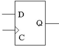
Здесь  $D$  — это вход данных,  $Q$  — выход, треугольником обозначен тактовый вход  $C$ .
