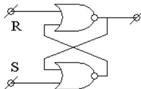
Схема состоит из двух логических схем 2ИЛИ-НЕ. Схема содержит два входа и один выход.
