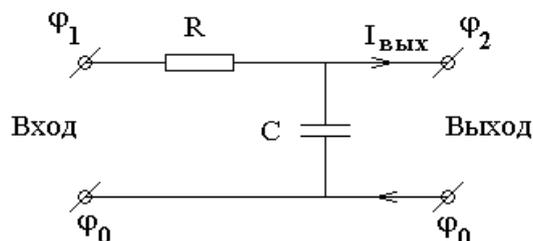
Здесь подразумевается, что к выходу схемы ничего не подключено и поэтому выходной ток схемы равен нулю  $I_{\text{вых}} = 0$ .
