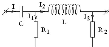
На схему в нулевой момент времени подают ступеньку напряжения с амплитудой  $U_0$ . Нужно найти напряжение на выходе схемы, как функцию времени.
