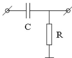
Пусть напряжение  $U_{ex}(t)$  на входе схемы — любая функция времени. Входное напряжение подается на последовательно включенные конденсатор  $C$  и резистор  $R$ , а с резистора снимается напряжение  $U_{вых}(t)$ . И пусть в любой момент времени выполнено условие  $|U_{вых}(t)| \ll |U_{ex}(t)|$ . Подразумевается, что ток на выходе схемы равен нулю, то есть к выходу ничего не подключено.
