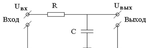
Надписи  $U_{\text{вх}}$  и  $U_{\text{вых}}$  можно не делать, так как обычно подразумевается, что напряжение подается на верхнюю клемму пары входных клемм и снимается тоже с верхней клеммы пары выходных клемм.
