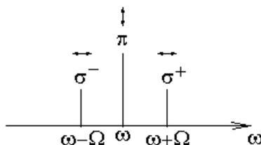
Если постоянного магнитного поля нет, то колебания диполя все равно можно разложить на  $\sigma^-$ ,  $\pi$  и  $\sigma^+$  компоненты относительно любой оси, так называемой оси квантования.
