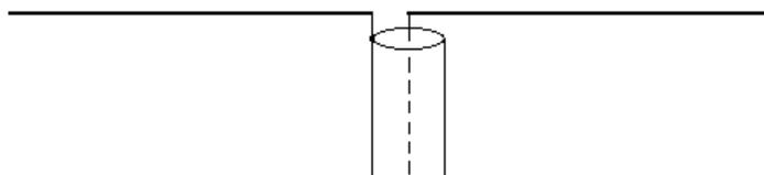
Простейшая антенна — два штыря и коаксиальный кабель, по которому сигнал подводится к передающей антенне.
