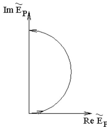
Для внутреннего и внешнего края зоны Френеля по определению зоны Френеля разность хода равна  $\Delta = \frac{\lambda}{2}$ , что соответствует разности фаз  $\delta\varphi = \pi$  и соответствует повороту вектора на комплексной плоскости на угол  $\pi$ . Если вклад от начала первой зоны смотрит направо, то от конца первой зоны — налево. Следовательно, картина сложения амплитуд на комплексной плоскости — половина окружности.
